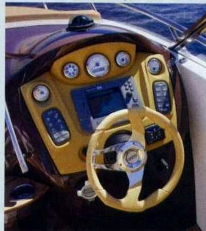
Sopra, d'impatto per colori e disegno il moderno ed ergonomico cruscotto realizzato in poliuretano a iniezione.
